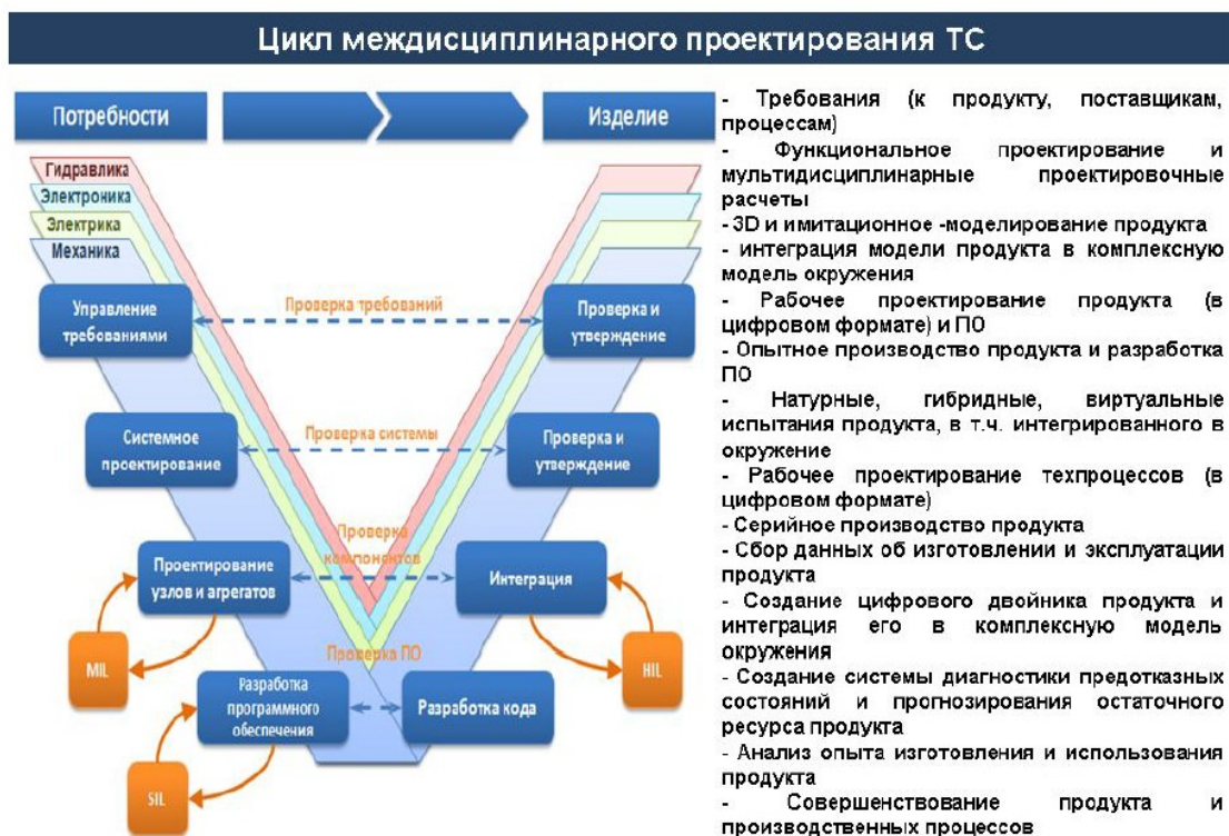
Рисунок 1.6 – Цикл междисциплинарного проектирования транспортных средств
