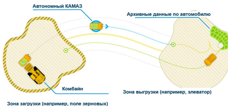
Рисунок 1.8 – Схема производственных работ, выполняемых РТС
