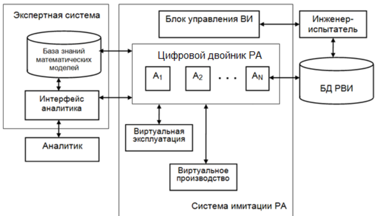
Рисунок 1.7 – Общая структура системы виртуальных испытаний агрегатов:
